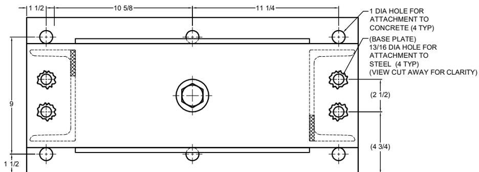
**MODEL M2SS-5D SEISMICALLY RESTRAINED VIBRATION ISOLATOR FOR 5" DEFLECTION**
